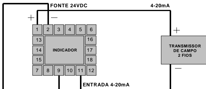
Figura 3 – Ligação de transmissor 2 fios com fonte do próprio indicador.
