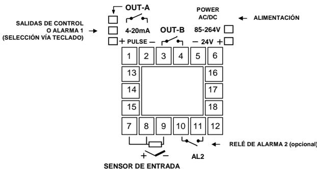
Figura 1 - Conexiones eléctricas del controlador
