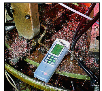
El instrumento de medición puede utilizarse en condiciones ambiente duras gracias a la funda de protección TopSafe suministrada
