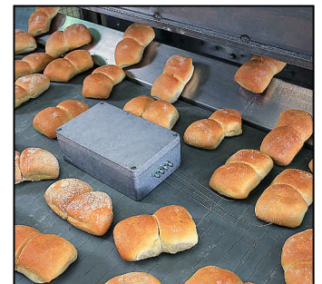
Control de la temperatura del horno en líneas de cocción con caja de protección de calor
